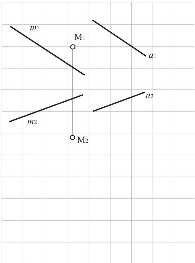
**6.3.10.** Определить расстояние между параллельными плоскостями  $\alpha(m, n)$  и  $\beta(a, b)$ .
