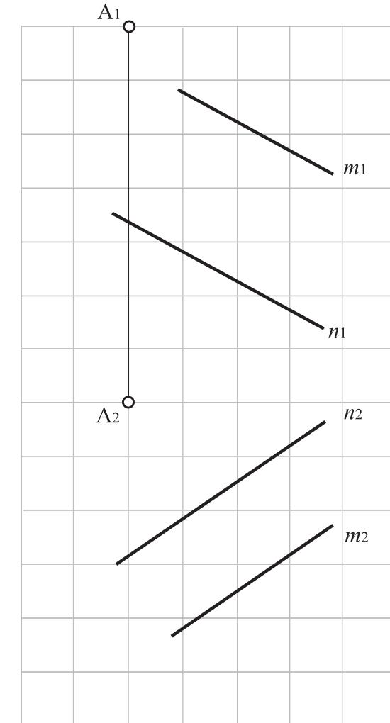
**6.3.6.** Определить расстояние от точки A до плоскости  $\alpha(m,n)$ , используя способ ДОП .
