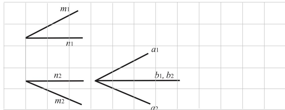
**6.3.11\***. Построить прямые, пересекающие прямую  $b$ , параллельные прямой  $a$  и отстоящие от последней на расстояние 20 мм.
