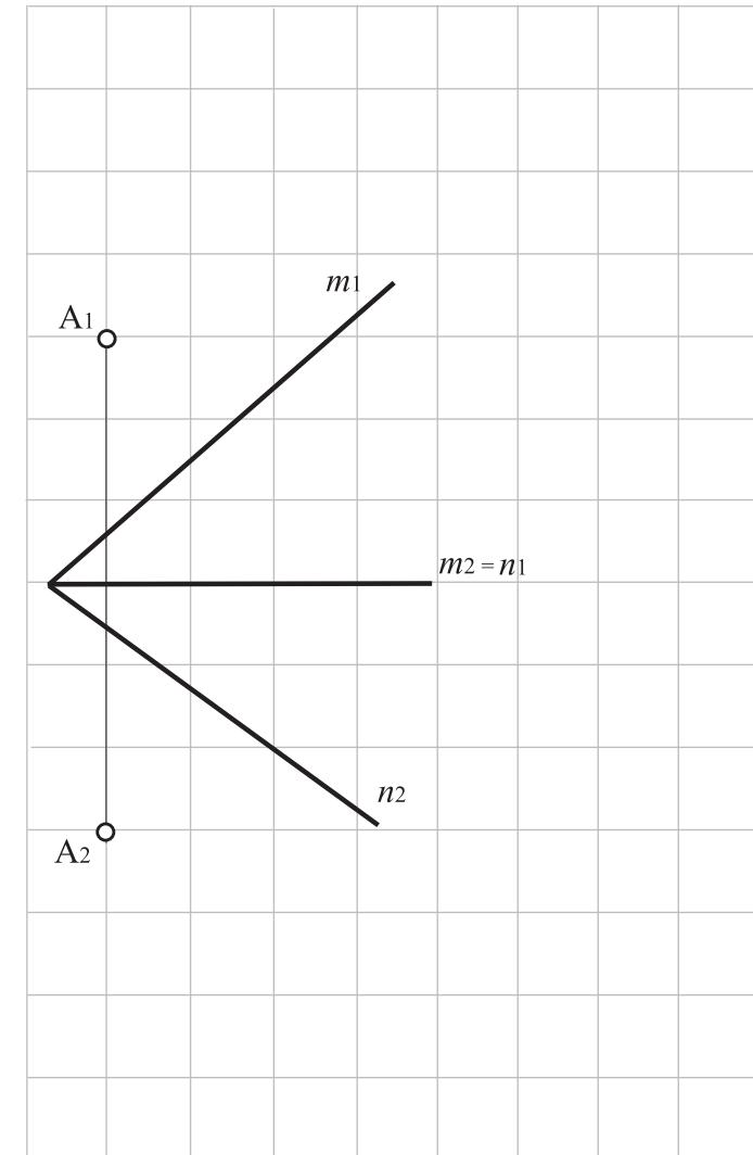
**6.3.7.** Определить горизонтальную проекцию точки А, если известно, что расстояние от нее до плоскости  $\alpha$  ( $m, n$ ) равно 15 мм.
