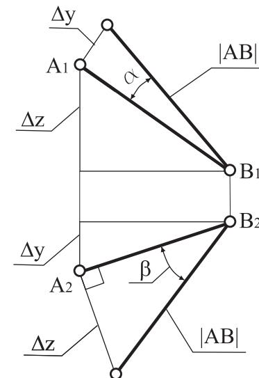
Длина отрезка равна гипотенузе прямоугольного треугольника, за один из катетов которого принимается его проекция, например  $A_2B_2$ , длина другого катета равна превышению концов отрезка в другом поле проекций ( $\Delta z$ ).
