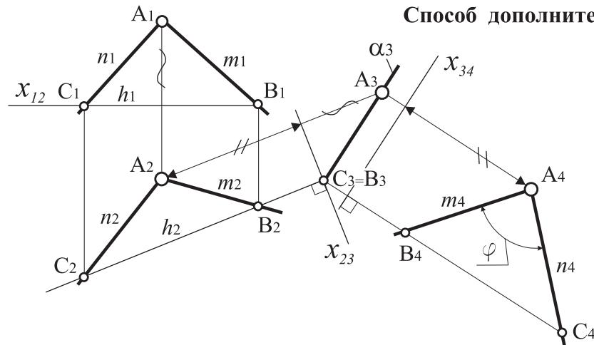
**Способ дополнительного ортогонального проецирования**
